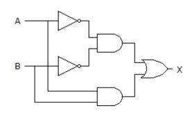
a) X=AB'+A'B b) X=(AB)'+AB c) X=(AB)'+A'B' d) X=A'B'+AB
